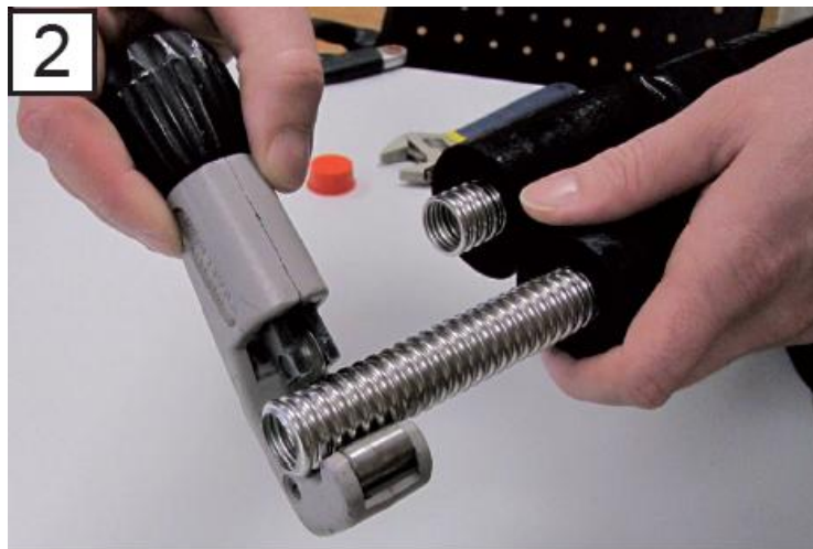
Tăiați țeava în locul dorit cu un dispozitiv de tăiat țevi
