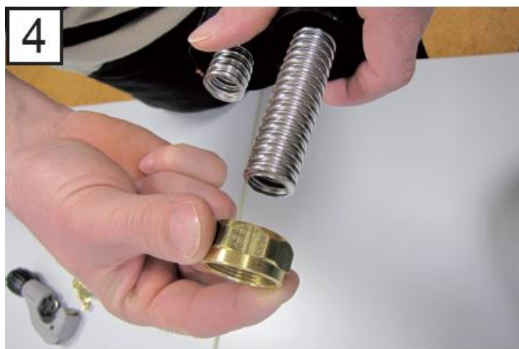
Montați piulița din alamă
